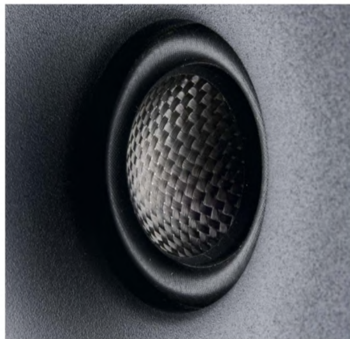
Das Kohlefaserwebes der Kalotte wird zu einer dichten, harten Struktur verbacken. Die großvolumige Sicke überrascht.
